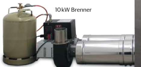
Abgasventilator Verbindungsrohre zwischen Ofen und Technik ca. 0,5m
