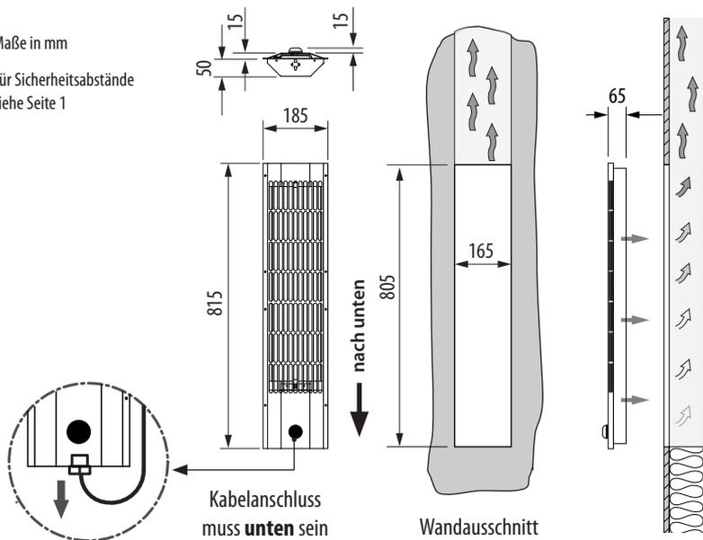
**⚠️ Brandgefahr!** Ausreichende Belüftung hinter und über dem Strahler muss gewährleistet werden. Der Raum über dem Strahler darf nicht blockiert sein, damit die warme Luft frei aufsteigen kann. Keine Deckenmontage! Achten Sie darauf, dass der Kabelanschluss nach unten ausgerichtet wird.
