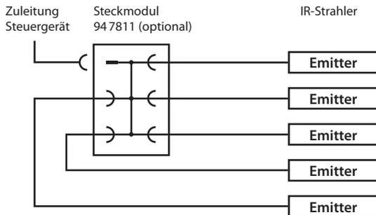
Bei 750 W Strahlern max. 4 Stück (3000 - 3500 W) bei 16 A Zuleitung. Steckmodul 94 7811 - optionales Zubehör.
