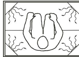
Die Montage der Strahler sollte so erfolgen, dass der Körper des Badegastes großflächig und möglichst rundum angestrahlt wird. Als vorteilhaft erweist sich eine Montage in den vier Ecken der Infrarotkabine.
