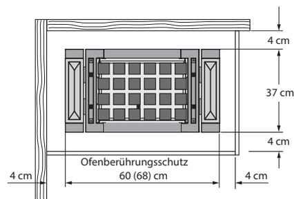
Bei zwei Verdampfer siehe Montage- und Gebrauchsanweisung, besondere Anschlussanforderung.
