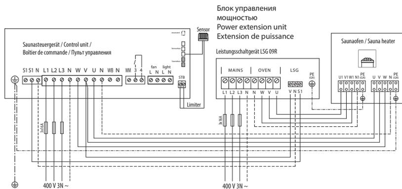
\*Umverdrahtung auf einkreisige Variante möglich, bei Verwendung eines Steuergerätes mit Zulassung für eine Leistung von 10,5 kW bei max. Phasenbelastung 16 A.
