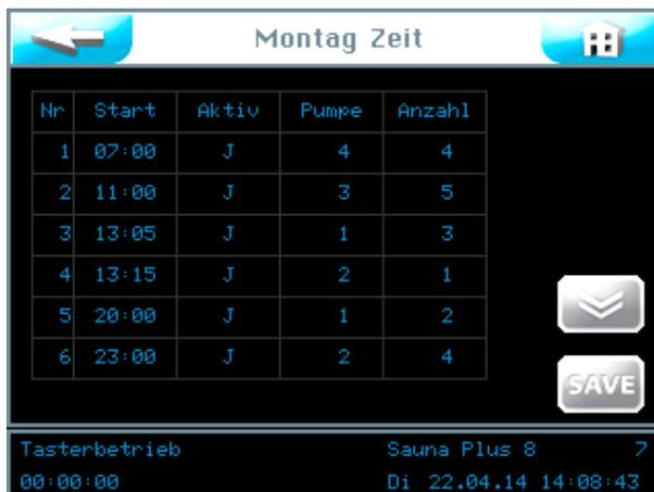
Sie können die Startzeiten in beliebiger Reihenfolge eingeben. Nach dem Speichern mit dem **SAVE** Button, werden die Zeiten automatisch sortiert.
