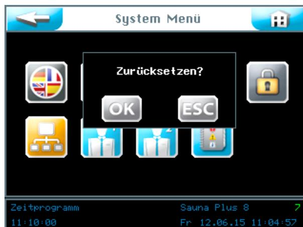
Bestätigen Sie die Auswahl mit **OK** damit die Software auf die Werkseinstellungen zurückgesetzt wird. Wenn Sie den Befehl mit **ESC** abbrechen bleiben
