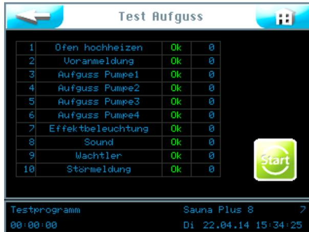
Sind alle Einzeltests mit  OK gekennzeichnet, so ist der Test beendet.
