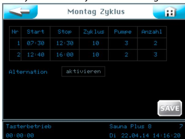
Hier sehen Sie die gefüllte Eingabemaske. Sie können 2 verschiedene Zeitblöcke mit den entsprechenden Parametern eingeben. In diesen Zeiträumen ist der eingestellte Zyklusbetrieb in der Saunakabine aktiv.
