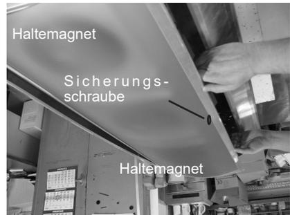
Durch ziehen löst sich der Scheibenrahmen aus den Magnethalterungen und kann nach unten geschwungen werden.
