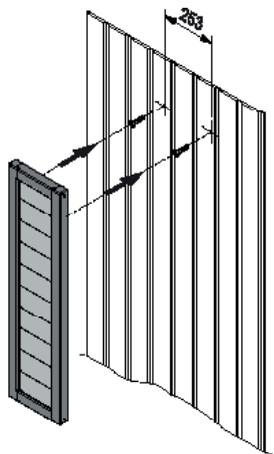
Aufhängung ausgelegt für Holz- oder Spanplattenschrauben 5,0
