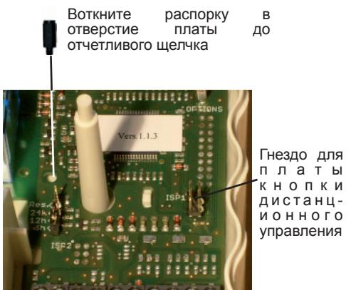
Проведите претерминированный соединительный провод через одно из отверстий для провода, и вставьте штекер в гнездо платы до отчетливого щелчка.
