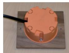
Das Ganze mit der Hohlwanddose in die erstellte Öffnung stecken und die Holzblende mit den beiden Spax-Schrauben 3 x 20 festschrauben.
