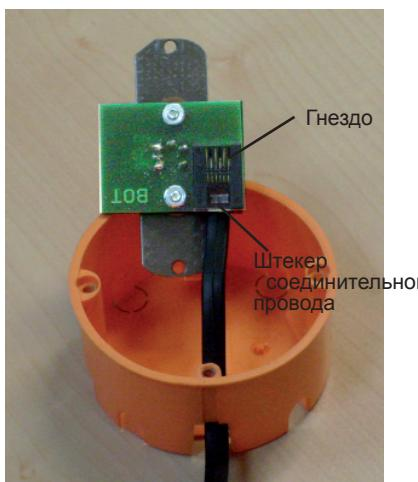
Теперь необходимо закрепить кнопку на полой стенной розетке с помощью обоих винтов с потайной головкой 3 x 16.
