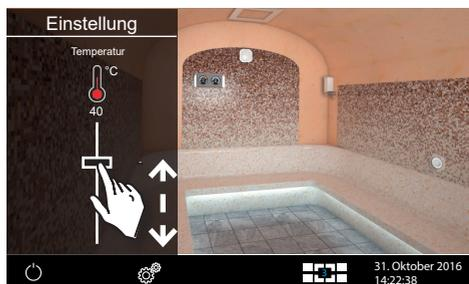
Ziehen Sie den Schieber nach oben oder nach unten, um die gewünschte Temperatur zu erreichen. Der neu eingestellte Wert wird sofort übernommen. Diese Einstellung können Sie auch im laufenden Betrieb vornehmen.
