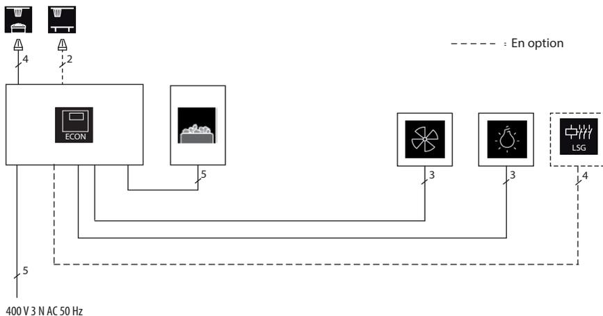
La lampe de contrôle doit être installée dans la pièce de la personne de surveillance lors d'installations publiques sans limitations de temps de chauffage
