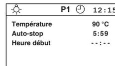
Si l'installation de sauna doit être utilisée sans temps de présélection, « -- : -- » doit être entré à l'écran sous temps de présélection.
