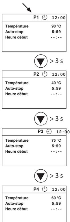
Les 4 configurations de cabines modifiables (P1-P4) permettent de régler différentes valeurs de température en mode finlandais.
