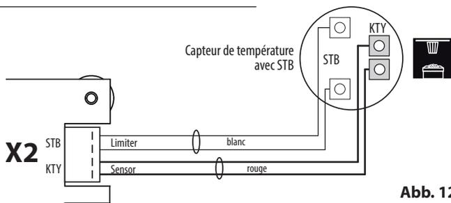
6. Après le montage intégral et le bon fonctionnement de l'appareil de commande, le câble pour la sécurité contre les températures trop élevées doit être contrôlé du point de vue court-circuit. À cette fin, débloquez l'un des câbles blancs sur le boîtier des sondes. Le message d'erreur correspondant apparaît sur l'écran.
