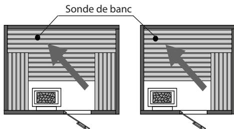
La sonde de banc est raccordée à l'appareil de commande par un câble en silicone à 2 brins sur les bornes situées sur la partie droite de la platine inférieure (voir illustration).
