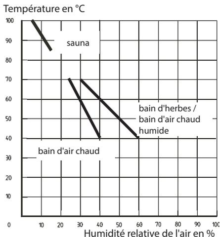
L'intensité d'humidité affichée sur l'écran correspond au réglage de l'évaporateur proportionnel au temps. L'écran ne permet donc pas le pré-réglage ni l'affichage de l'humidité relative de l'air mais affiche la fréquence d'allumage de l'évaporateur en pourcentage. Le graphique a pour but de le concrétiser.
