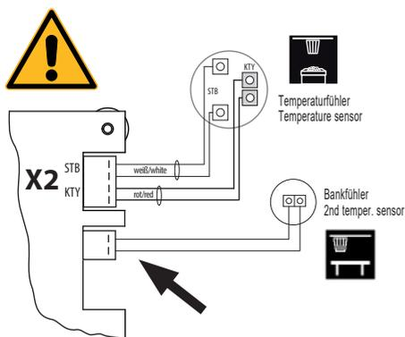
Si le raccord est effectué correctement, l'appareil de commande le reconnaît automatiquement une fois l'alimentation électrique réactivée.
