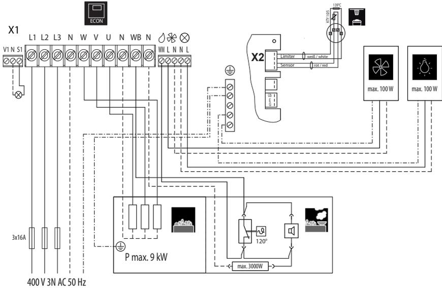
**⚠ Attention :** branchez toujours le fil neutre (N) du poêle du sauna. Lors de l'utilisation humide, une phase du poêle de sauna est éteinte, c'est-à-dire que la charge de chauffe n'est alors plus symétrique. Le fil neutre n'est donc alors plus sans tension.
